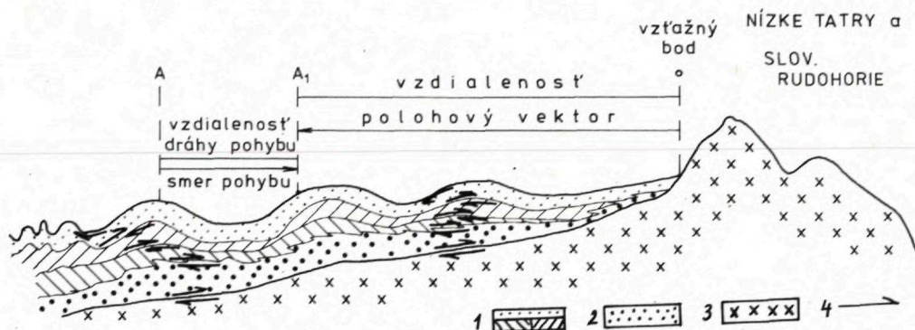
Obr. 2 Schematické znázornenie pohybu bodov v deformovanom vnútrokarpatskom paleogéne (1 — flyš centrálno-karpatského paleogénu, 2 — báza paleogénu, 3 — podložie paleogénu, 4 — smer zvyšovania odporu trením)
